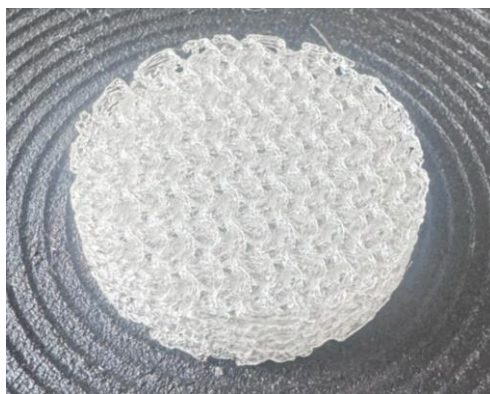
Slika 4. Nosač za imobilizaciju enzima dobijen 3D štampom
