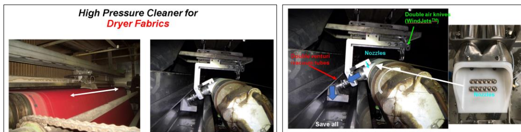
Figure 7. High pressure Cleaner for Dryer Fabric Slika 7. Visokopritisni sistem za čiščenje sušne tkanine.
