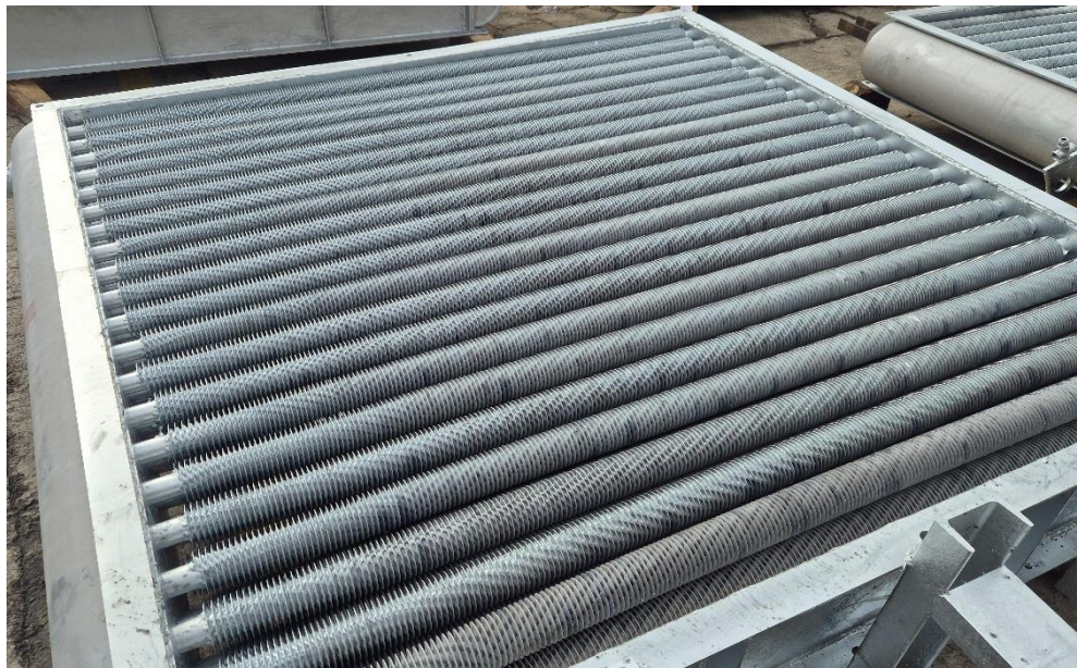
Slika br. 1 - Spiralno orebreni razmenjivač toplote Figure 1. Heat exchanger with spiral fins.
