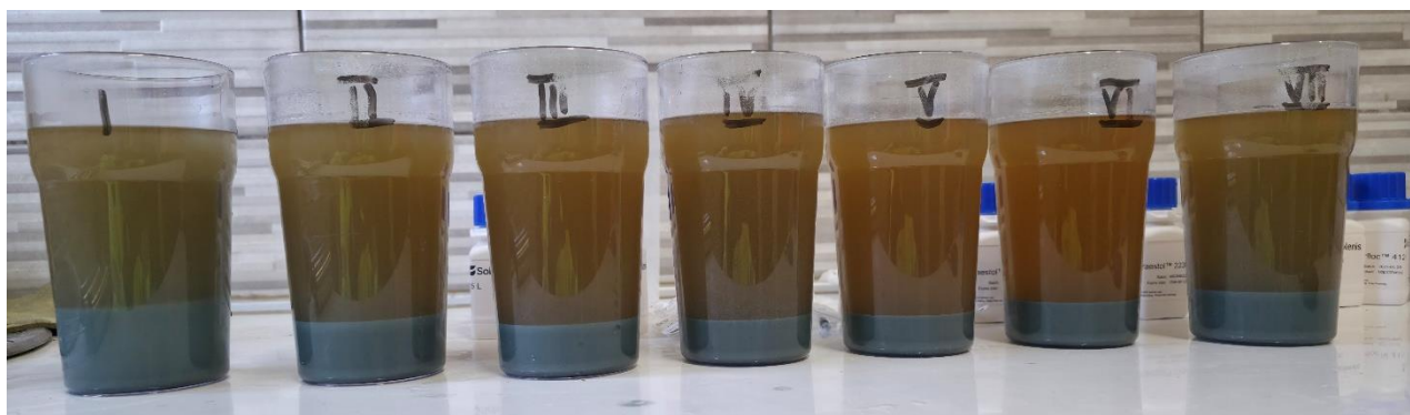
Slika 5. Rezultati doziranja različitih polimera u prvoj minuti (čaha I bez polimera, čaše II, III, IV, V, VI, VII sa polimerima u količini 4 ppm)
